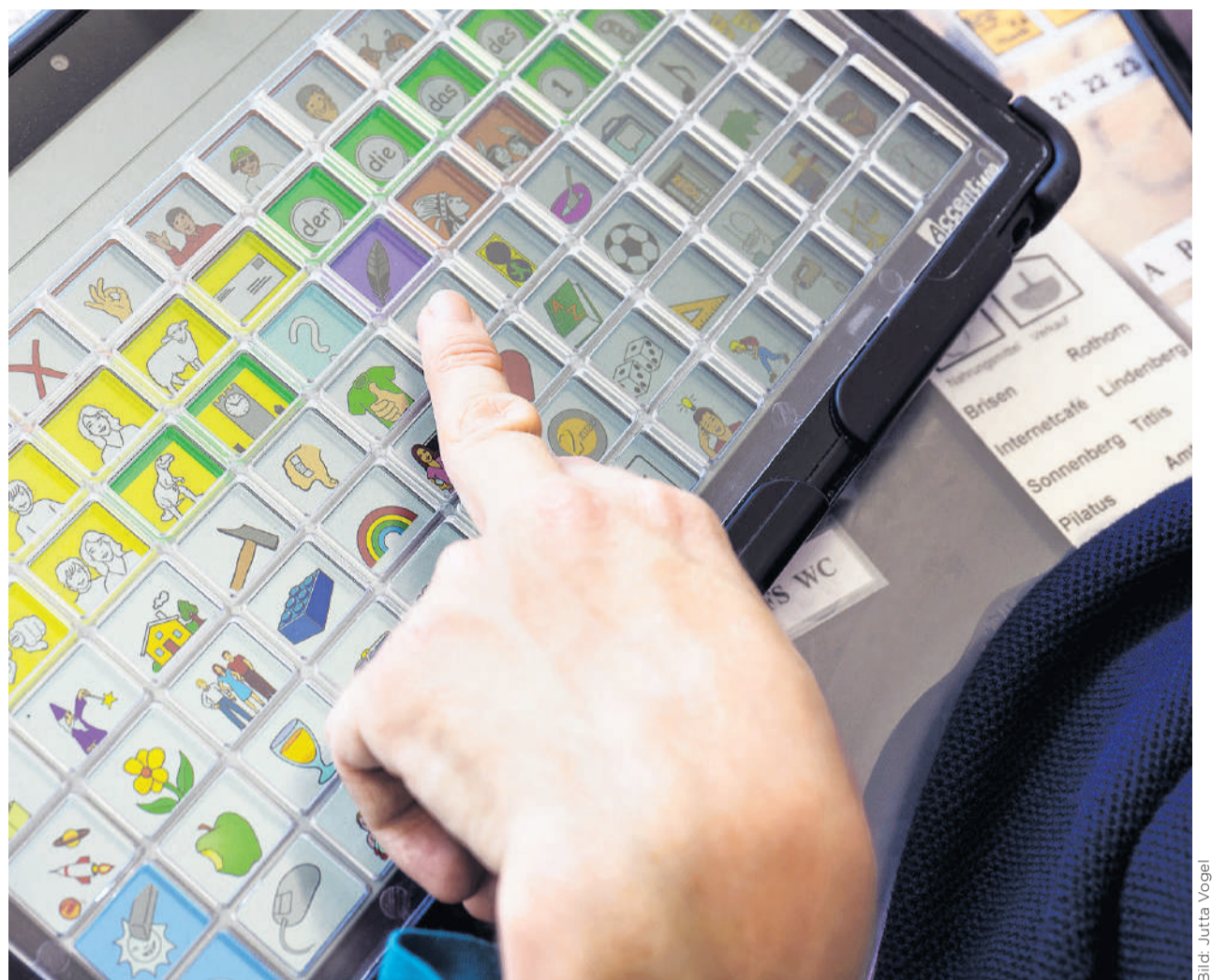
Der «GoTalks» mit Sprachausgabe und individuell programmierbaren Symbolen und Bildern vereinfacht die Kommunikation.
